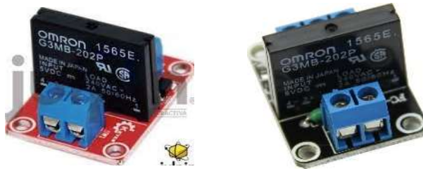
Modulo 1 Relay ESTADO SOLIDO 5v
