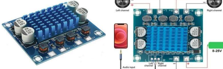
Amplificador audio TPA-3110 30+30w - 8 a 26v
