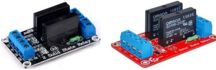
Modulo 2 Relay ESTADO SOLIDO 5v
